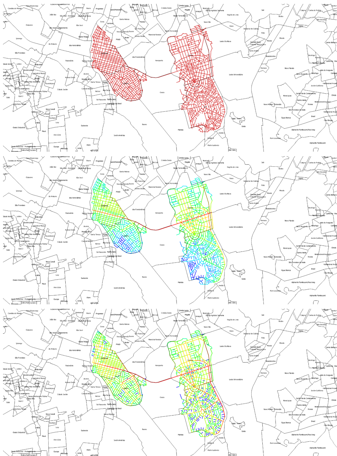
Figura 3. Modelagem configuracional do sistema urbano de Goiânia em 1939, com sobreposição de bairros atuais: representação linear (em cima), variável NAIN (centro) e variável NACH (embaixo) (fonte: Modelagem de André Torres e Elisângela Costa. Escala Aproximada 1:25000)
