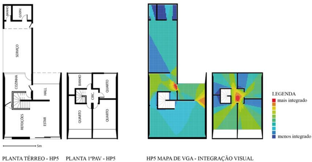
Figura 11. Planta baixa HP5 e respectivo mapa VGA (fonte: elaborado pelas autoras com base no original disponível na ArPDF).
