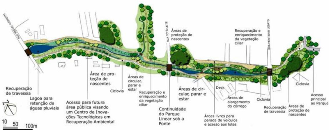
**Figura 2.** Projeto de Parque Linear, onde é observado o plano de vegetação para a margem do córrego e a integração com usos públicos. Fonte: Peres, Mendiondo e Porto (2005).
